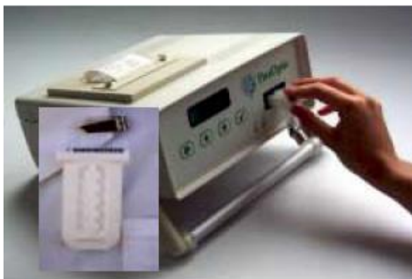
8 órára vonatkozó átlagos sztirol koncentráció mérésére alkalmas aktív szenet tartalmazó mérő és analízáló berendezés
