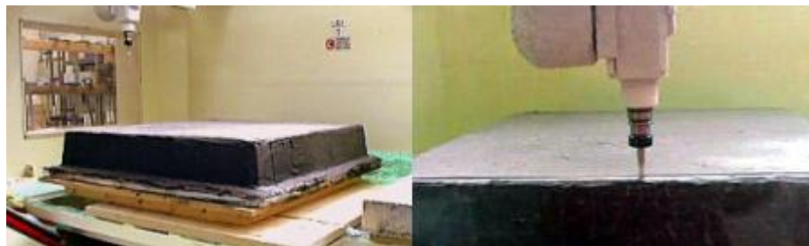
5. ábra Csiszolás CNC géppel
