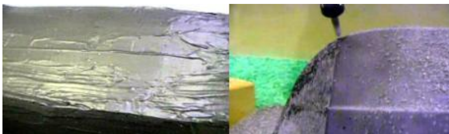
3. ábra Gélezett felület minősége és csiszolása
