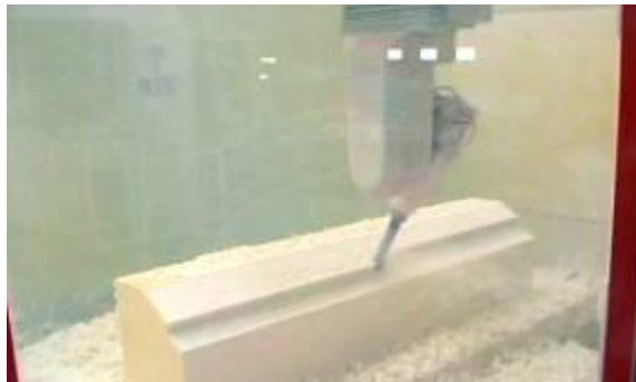
1. ábra Poliuretánhab alakítása CNC géppel
