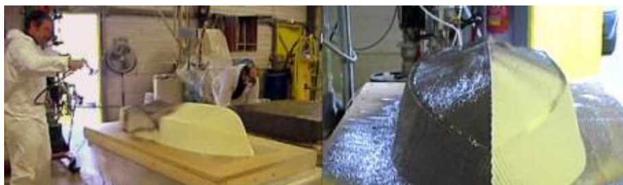
2. ábra Csiszolható gél felvitele
