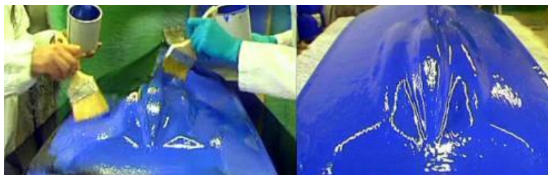
2. ábra Szerszámgél felvitele ecsettel
