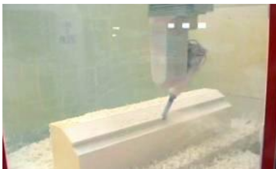
4. ábra Poliuretánhab alakítása CNC géppel
