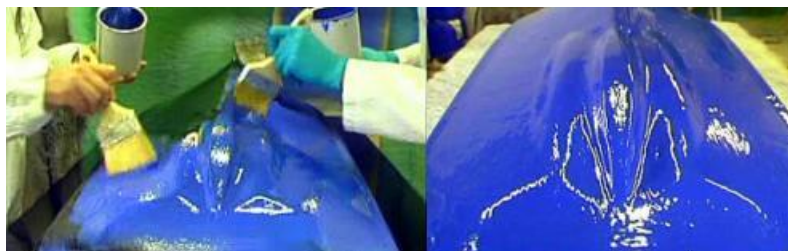
4. ábra Szerszámgél felvitele ecsettel
