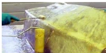
8. ábra Kézi laminálás
