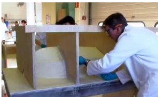
60. ábra Keret belaminálása
